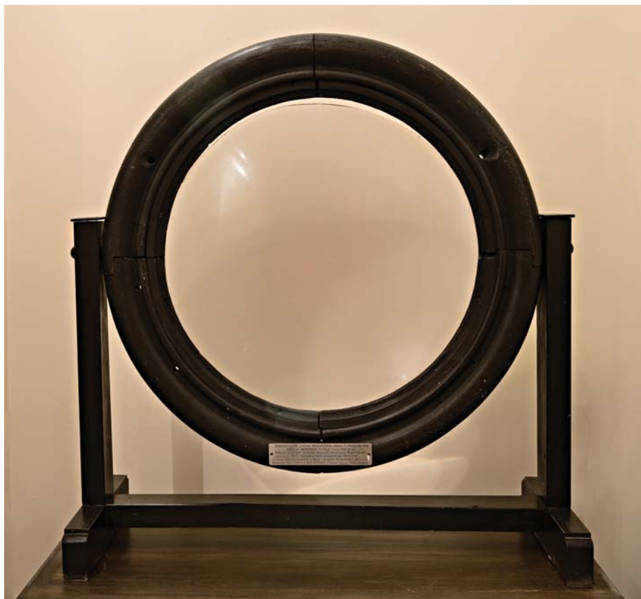
Илл. 4. Основная линза зажигательного инструмента работы Э.В. Чирнгаузена. Изготовлена в 1699 г. Диаметр ее 57.5 см, толщина в центре 5.2 см
