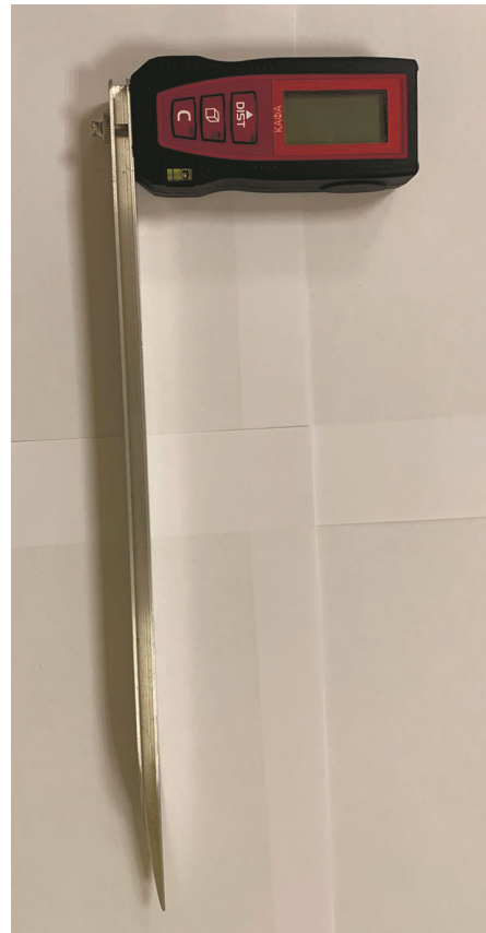
Рисунок 1. Общий вид антропометра КАФА-Лазер (КАФА, Россия) Figure 1. General view of the KAFA-Laser anthropometer (KAFA, Russia)
